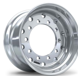
SLT 2899 / SLT 3099 - 22.5x11.75" ET 0, Diamond cut och högglangspolerad SLT 2899 - (26 mm), 4 500 kg max belastning SLT 3099 - (26 / 32 mm), 5 000 kg max belastning Släpvagnar | Lastbilar
