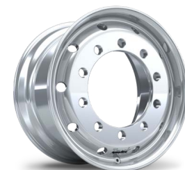
SLT 3018 - 22.5x11.75" ET 120 (26 / 32 mm) 5 000 kg max belastning Diamond cut och högglangspolerad Släpvagnar | Lastbilar
